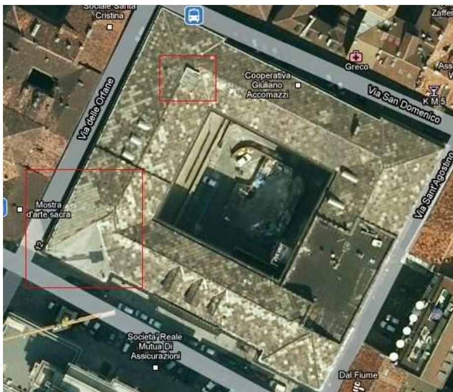
Particolare di copertura – in rosso tratti con lastre in amianto
