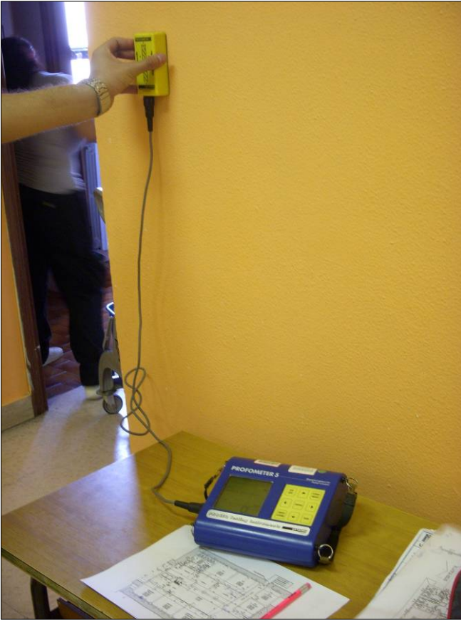
Figura 17 - Esecuzione di un rilievo con pacometro
