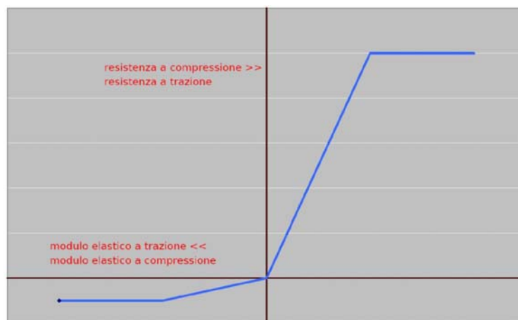
Figura 1 Diagramma Sforzi-deformazioni per la muratura (qualitativo)
