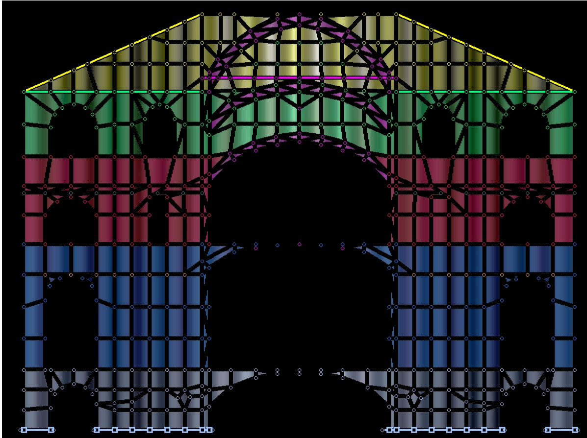
FIG. 4 - MESH GUSCI PER SETTI RADIALI R1+R5
