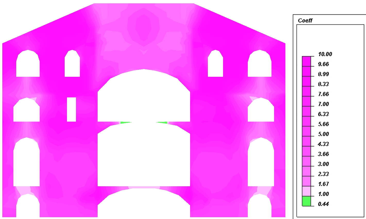
FIG. 39B - COEFFICIENTE DI SICUREZZA GLOBALE – MODELLO CON LIVELLI RIGIDI
