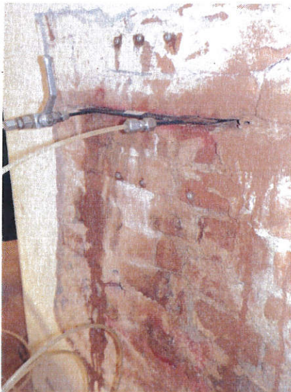
Figura 32. Martinetto piatto – prova di tipo A
