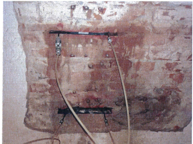
Figura 33. Martinetto piatto – prova di tipo B
