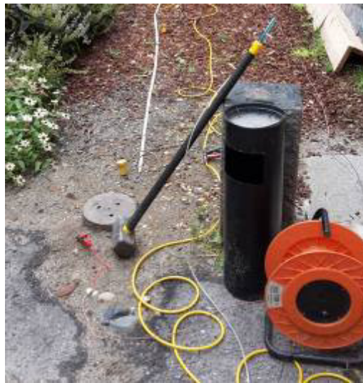
Figura 2 : particolare della piastra di contrasto utilizzata per l'energizzazione
