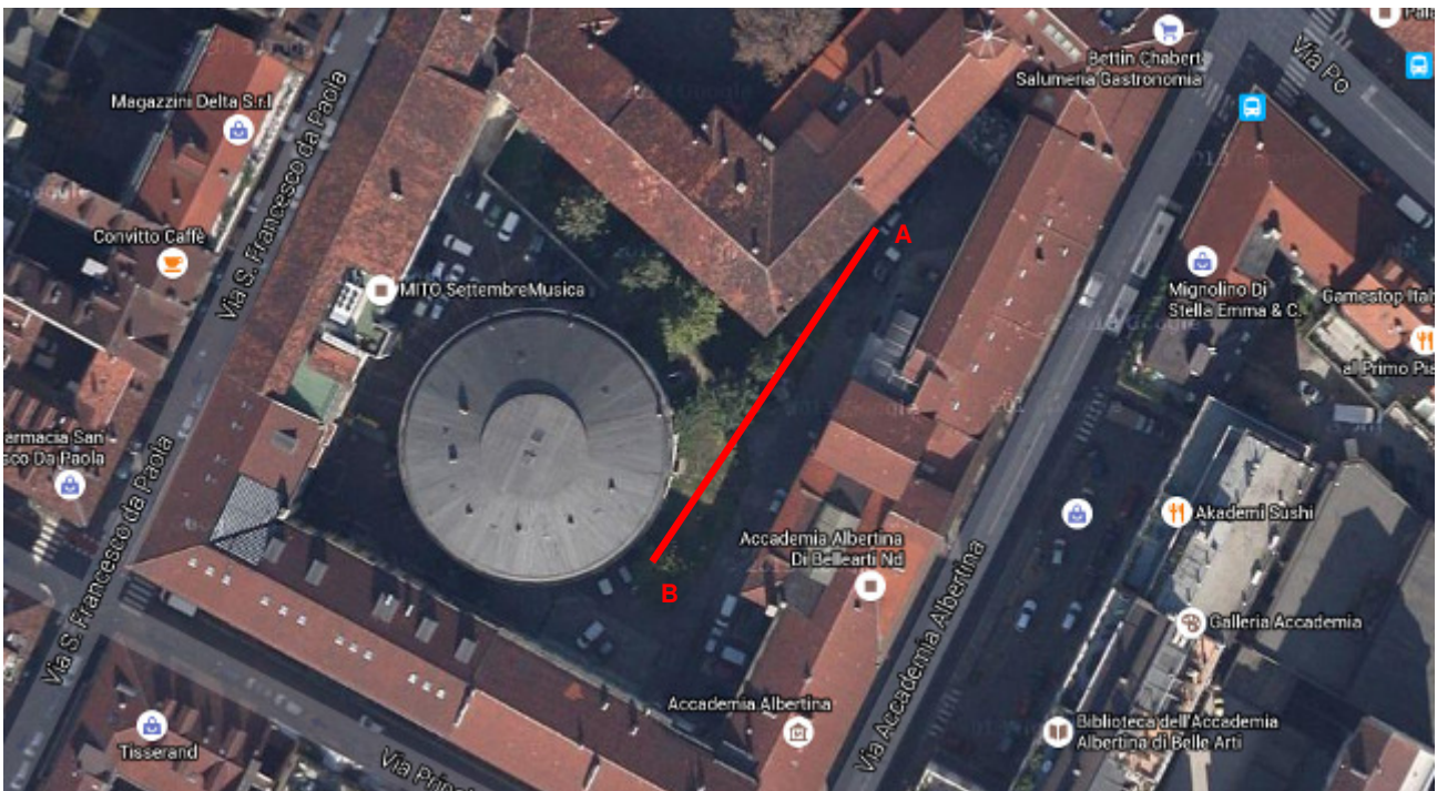
Figura 1 : ubicazione dello stendimento di geofoni. La lunghezza è 46 metri
