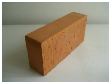
Figura 19.1 - Esempio di mattone pieno \square \leq 15\% in laterizio per murature portanti 2
