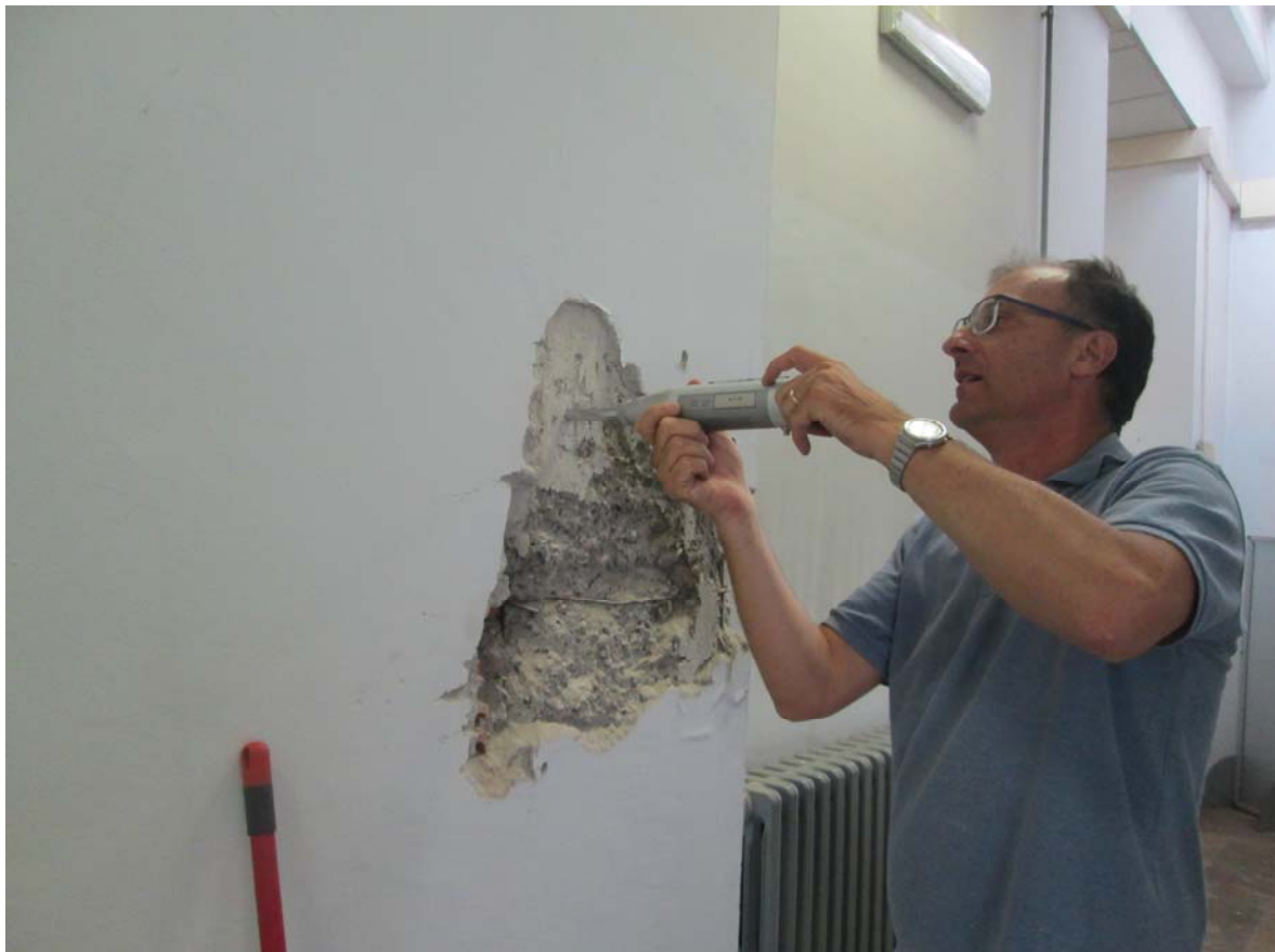
Foto n.24: prova sclerometrica n.2
