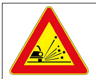
Figura II 390 Art. 31 Materiale instabile sulla strada
