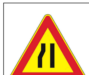
Figura II 386 Art. 31 Strettoia asimmetrica a sinistra
