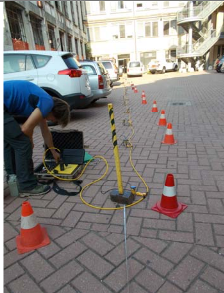
Stendimento indagine sismica attiva MASW
