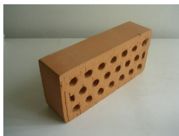
Figura 19.2 - Esempio di mattone semipieno 15\% < \square \leq 45\% in laterizio per murature portanti 4
